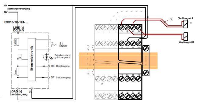
Wie hier gezeigt, kann die Versorgung des Steuerteils der POS-123-P an den Klemmen 3/4 ebenfalls über den Automaten erfolgen oder separat abgesichert werden.
